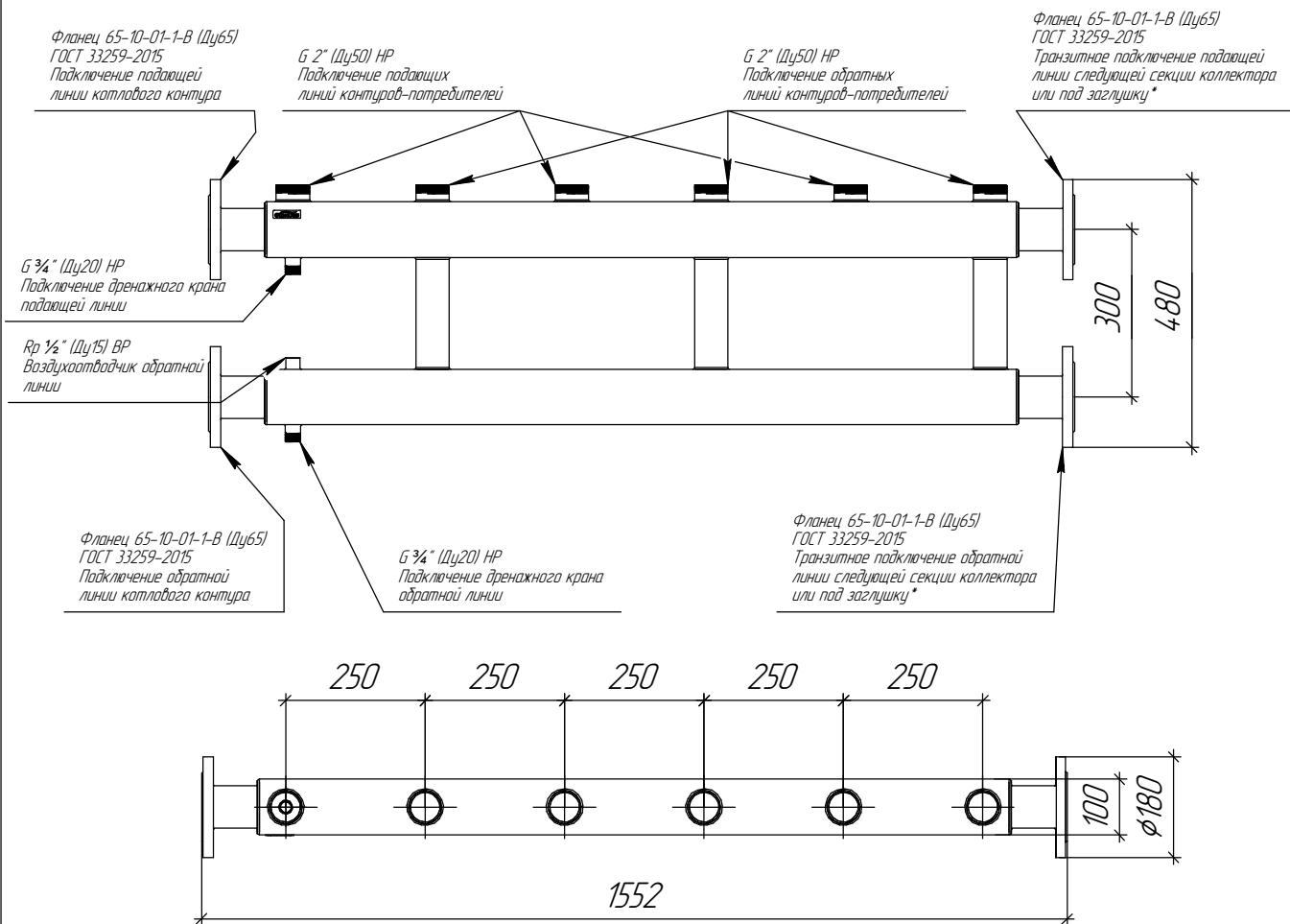
\*При стыковке с другим коллектором для фланцевых соединений необходимо использовать сильфонный компенсатор.
